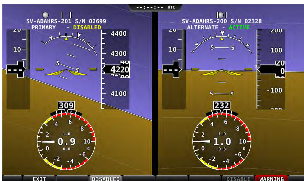
Figure 34 - Comparaison entre les deux ADAHRS ( l'une est déconnectée)
