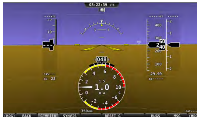
Figure 36 - Accéléromètre sur le PFD
