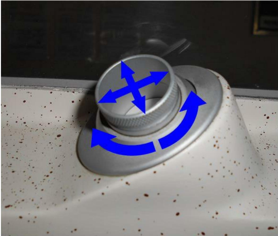
Figure 7-29 : Entrées d'air pour ventilation du cockpit
